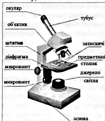
Рис. 1. Будова світлового мікроскопу
